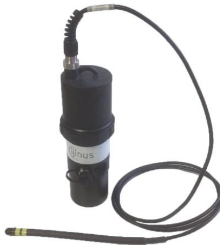
Capteur logger 2G/GPRS/3G et son antenne type déportée
